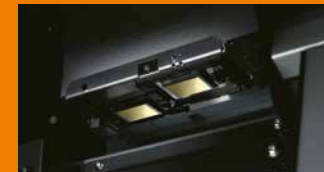
Zwei Druckköpfe in "gestaggerter" Anordnung
